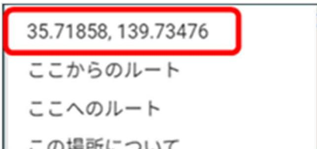
②Revitで読み込んだプロジェクトの「測量点」と同じ位置にマウスカーソルを合わせ、右クリックをすると左記のように緯度経度座標情報が表示されますのでこの値を記録しておいてください。
